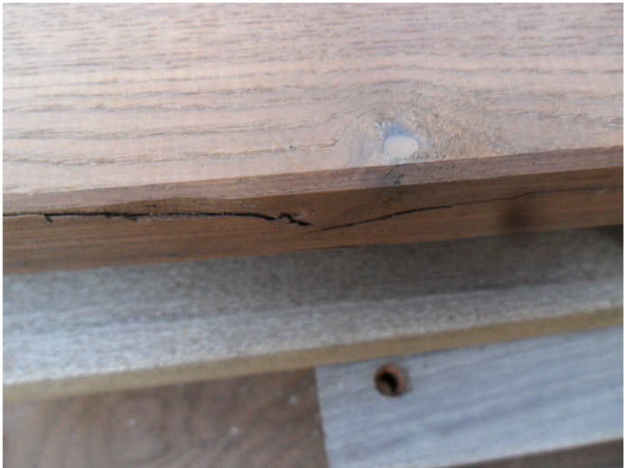
Risse in der Brettdicke (nicht in die Fläche übergehend) -> müssen akzeptiert werden
